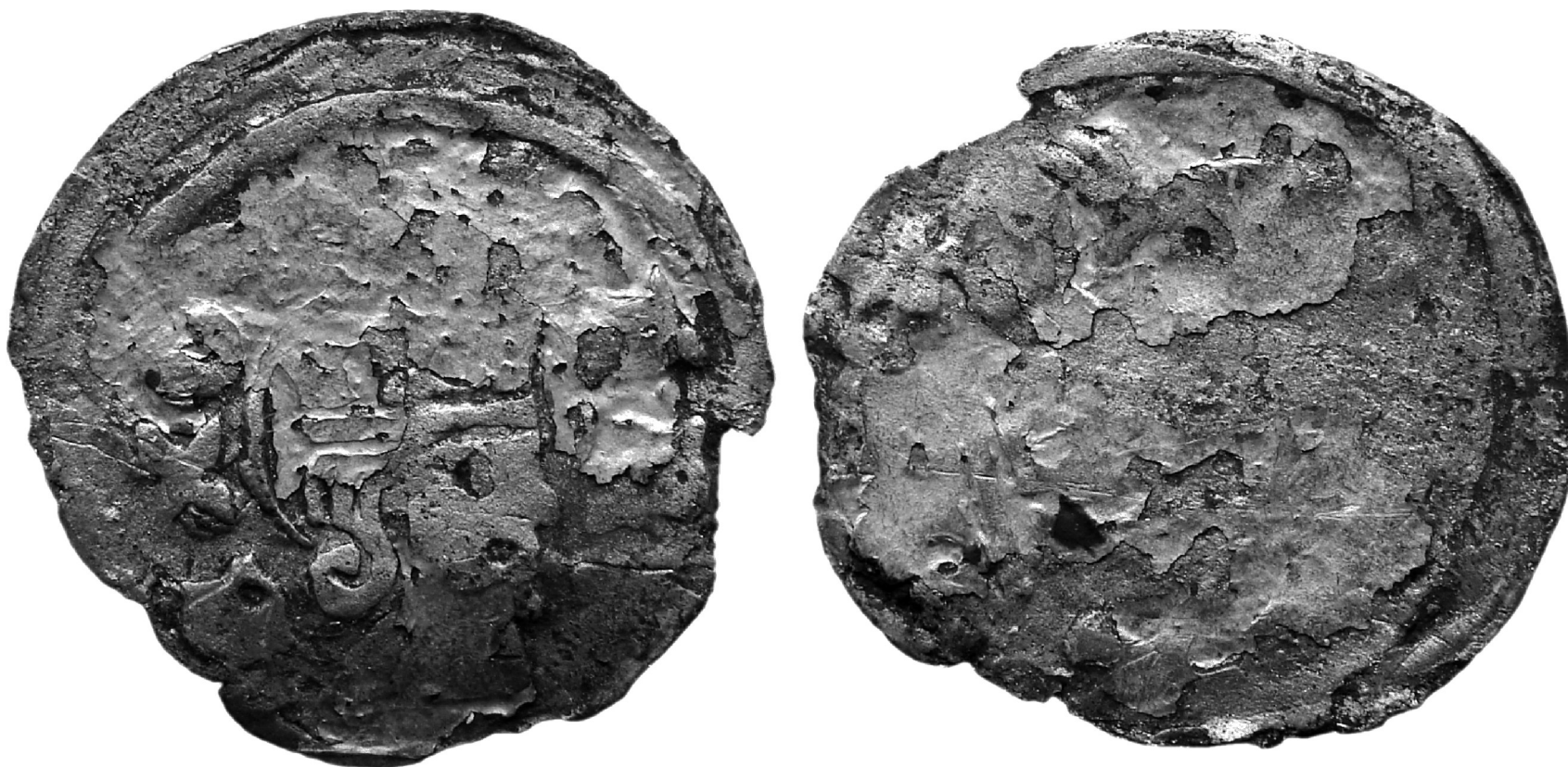
Obr. 1. Analyzovaný vzorek č. 1, w_{Ag}(RFA) = 94,1 \% , vypočteno 72,2 \% Ag
